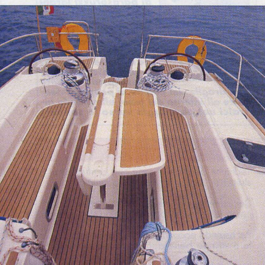
La larghezza del pozzetto ha permesso di piazzare un tavolo fisso ad ante abbattibili.
