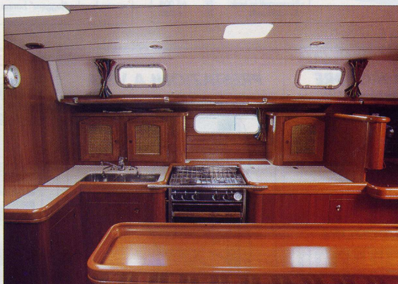
Spaziosa e ben ventilata la cucina, che dispone di un frigo elettrico ad apertura verticale, di un "frigoboat" a pozzetto e di un fornello a tre fuochi.
