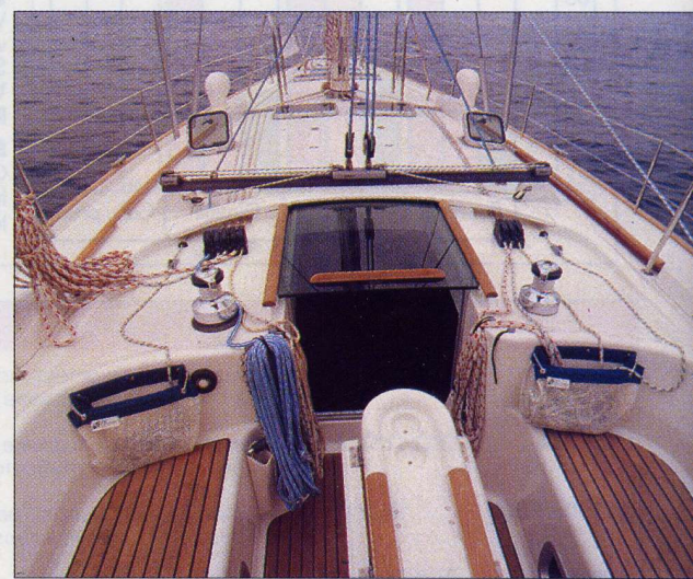
La scotta della randa e le drizze principali sono rinviate al winch elettrico, posto sul lato sinistro della tuga.
